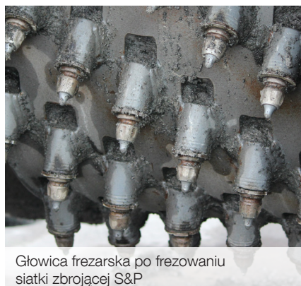
Pozostałości włókien w zmielonym materiale
