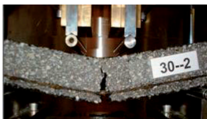
2 Próbka ze zbrojeniem z siatki o niskim module sprężystości
